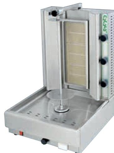
Le grill gyros gaz GR 40 G permet de cuire une broche de viande kebab ou gyros de 15 kg grâce à 2 brûleurs infrarouges avec régulation individuelle. Pour cuire la pièce de viande de façon homogène, le dosseret et la source de chaleur sont mobiles et réglables par rapport à la broche de viande permettant d'adapter la cuisson au volume de la broche de viande dite « carotte ».
